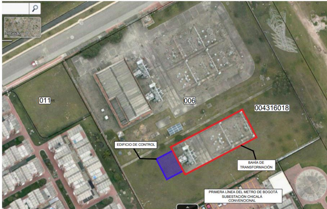
Ilustración 3.4.6-5. Predios contemplados para la ampliación de la subestación Chicalá
