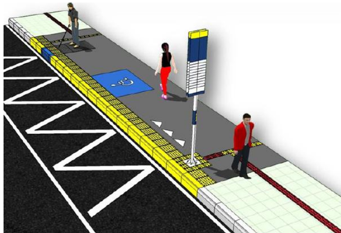
Ilustración 3.4.6-6. Paradero sin módulo M-10
