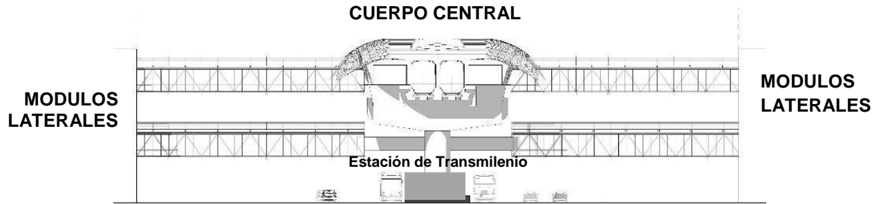
Ilustración 3.3.4-6. Vista frontal de una estación interconexión. Fuente: Elaboración propia
