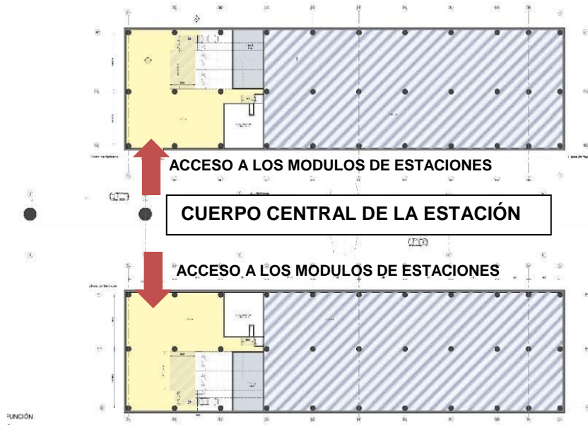
Ilustración 3.3.4-3 Planta baja de una estación sencilla. Fuente: Elaboración propia
