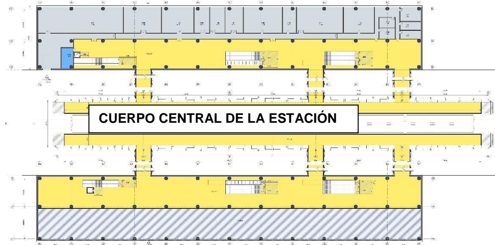
Ilustración 3.3.4-9. Nivel 3 o nivel de andén de una estación interconexión. Fuente: Elaboración propia
